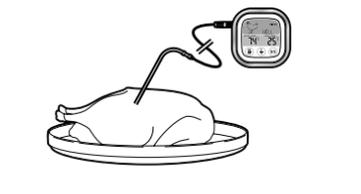
2. Stecken Sie den Temperatursensor so weit wie möglich in den dicksten Teil des Garguts. **Messen Sie nicht zu nah unter der Oberfläche, direkt am Knochen oder in einer Fettschicht!**
